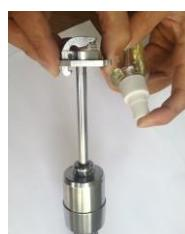
擦拭机芯中的弹击锤和弹击杆的内孔、撞击面；擦拭中心导杆导向法兰及挂钩部位。有条件可以用汽油等清洁剂彻底清洁干净；然后组装好这几个部件，在中心导杆上面涂两滴缝纫机油或钟表油。
