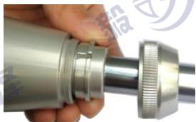
左手握紧下壳体，右手逆时针旋转前盖。如果遇到难以拧开的状况时，请在前盖和筒体接缝处滴入润滑油或用钳口工具打开；打开后请拉弹簧座即可以取出两个半圆状的卡环。
