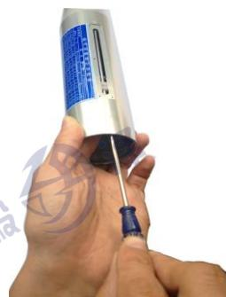
安装指针轴和指针块时使指针带有红线的面朝外，使凸起部分嵌入长条槽中，顺时针拧紧指针轴。
